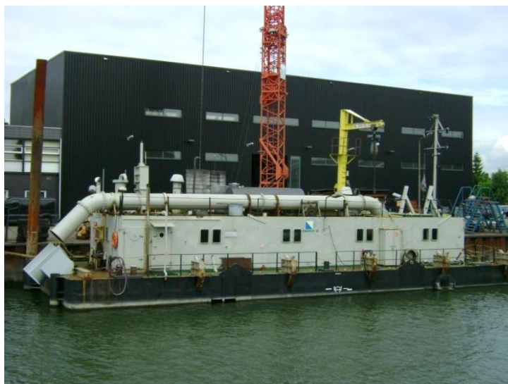
Figura 36. Ejemplo de estación de rebombeo
